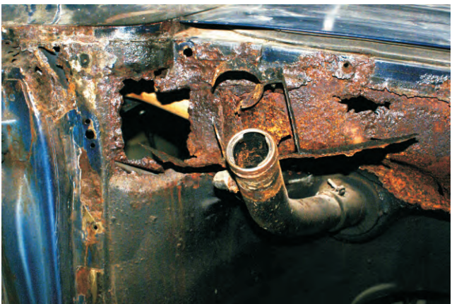
neuer Schweller unbehandelt wieder durchgerostet
