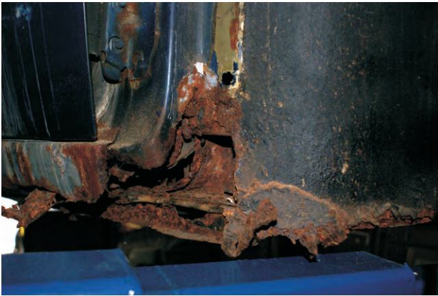
neuer Schweller unbehandelt wieder durchgerostet
